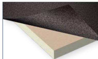
Pannello isolante in schiuma polyiso accoppiato a membrana bitume polimero da 3 kg/m<sup>2</sup> armata in velo di vetro App -5°C.
