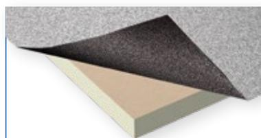
Pannello isolante in schiuma polyiso accoppiato a membrana bitume polimero da 4,5 kg/m<sup>2</sup> armata in tessuto non tessuto di poliestere e con finitura in scaglie di ardesia App -10°C.
