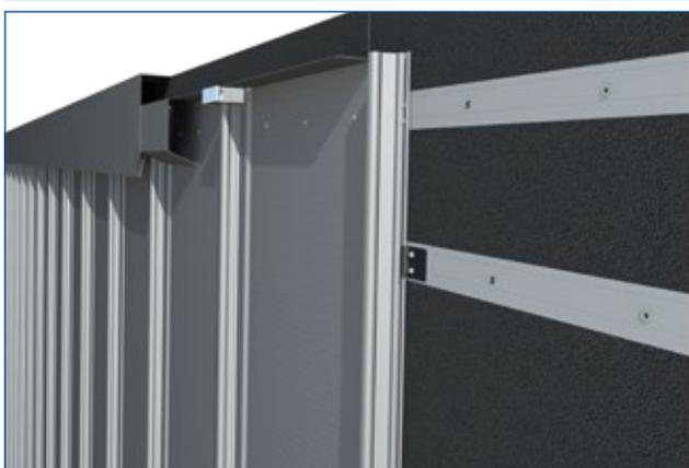
Particolare del sistema di fissaggio della scossalina di chiusura superiore con morsetto Future Base Light e profilo Future Lower Staffa di bloccaggio Future Staf ancorata sul profilo STIFERITE WallEvo
